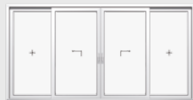
Schema C 2 Hebe-Schiebeflügel, 2 Festverglasungen
