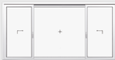
Schema K 2 Hebe-Schiebeflügel, 1 Festverglasung
