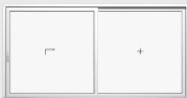
Schema A, DIN links 1 Hebe-Schiebeflügel, 1 Festverglasung
